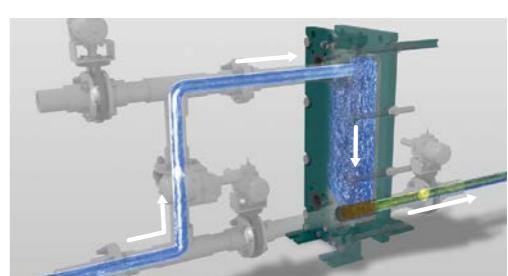
バルブの切り替えで通常流れを逆流流れに切り替えることによりインナーストレーナ内の異物を排出します。
