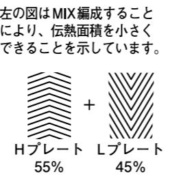
この例では、100枚のプレートのうちHプレートが55枚、Lプレートが45枚のMIX編成となります。
