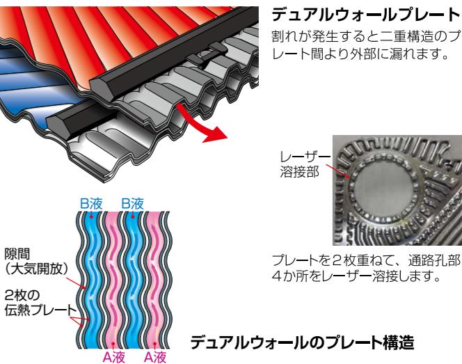
デュアルウォールプレート式熱交換器はプレートの二重構造化で2流体のコンタミネーションを防ぐ用途に安全と安心を実現する熱交換器です。
