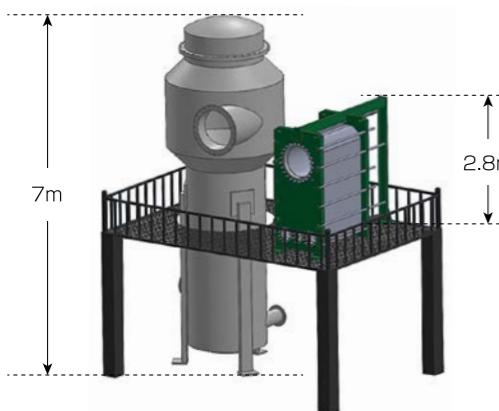
縦型多管式熱交換器とサイズ比較
