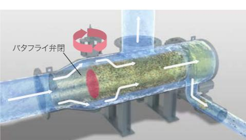
海水の異物をエレメントで除去し、ろ過された海水がエレメント内から外に向かって流出しプレート式熱交換器内に送られる。
