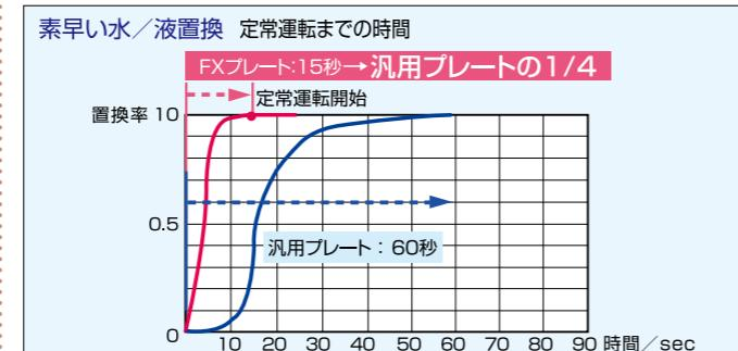
プレート流路におけるピストンフローが実現されたFXプレートは、液置換時間が従来プレートと比べ4分の1に短縮されるので、その間の製品ロスが75%も大幅に削減されます。
