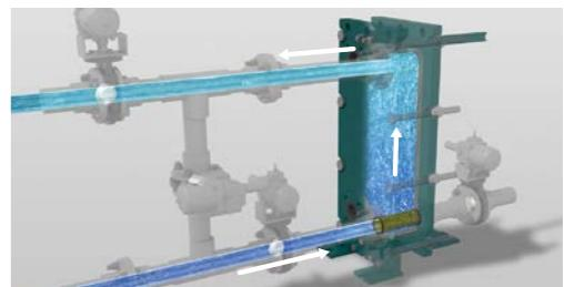
プレート式熱交換器の通路孔に挿入されたインナーストレーナで海水中のゴミ、異物を除去します。
