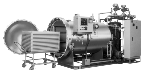
熱水スプレー式レトルト殺菌装置 (RCS：高温高圧調理殺菌装置)
