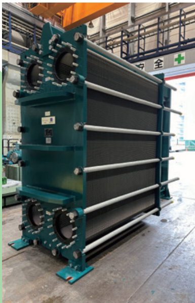
大阪・関西万博に採用されたプレート式熱交換器
