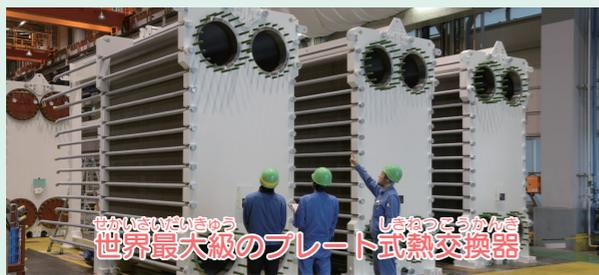
世界最大級のプレート式熱交換器
