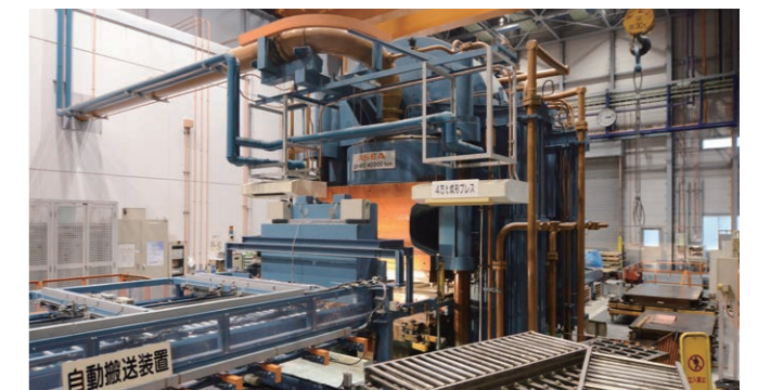
4万トンプレスライン 世界最大級の4万トンプレスラインは成形プレス・割れ検査装置・搬送装置で構成された自動化ラインです。LNGプラントなどで使用される世界最大級のスーパージャンボプレートをはじめとして、さまざまなタイプの大型チタンプレートを生産しています。「大型プレートの日阪」を支える基幹ラインです。
