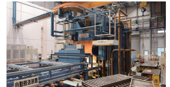
4万トンプレスライン 世界最大級の4万トンプレスラインは成形プレス・割れ検査装置・搬送装置で構成された 自動化ラインです。LNGプラントなどで使用される世界最大級のスーパージャンボ プレートをはじめとして、さまざまなタイプの大型チタンプレートを生産しています。 [大型プレートの日阪]を支える基幹ラインです。
