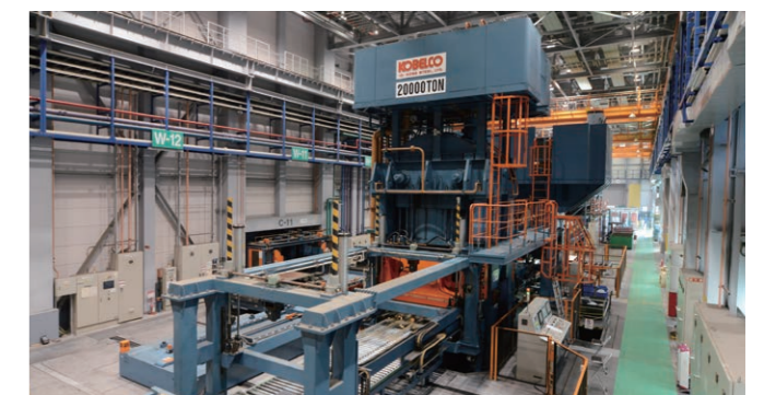
2万トン自動プレスライン 成形プレス・トリミングプレス・割れ検査装置・搬送装置・プレート集積装置・金型交換装置等で構成された全自動の無人プレスラインです。従来の1.5倍の生産性を実現した高効率なプレスラインは、中型から大型までのプレートサイズに幅広く対応できる最新鋭のラインです。
