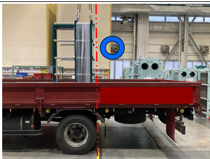
トラック後輪より前方に載せる
