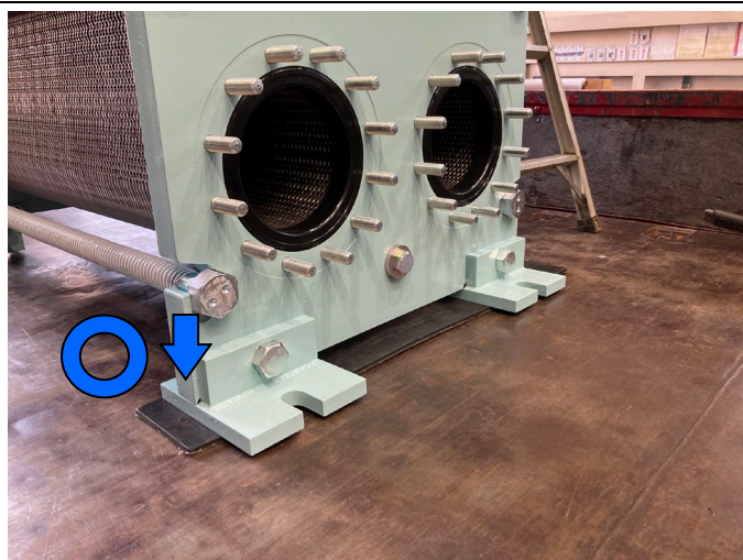
熱交換器と荷台が共に金属の場合、 Sフレームの真下にゴムシートを敷いてください
