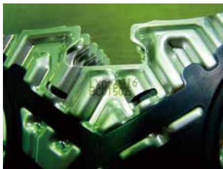
↑プレートのロット表示部分。型式 LX-026、S316 は SUS316であることを示しています。
