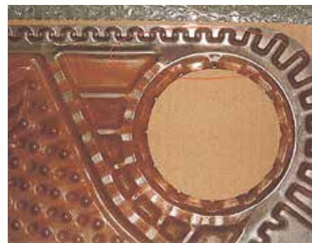
← 通路孔部(プレート裏面より)大きく変形しているのがわかる
