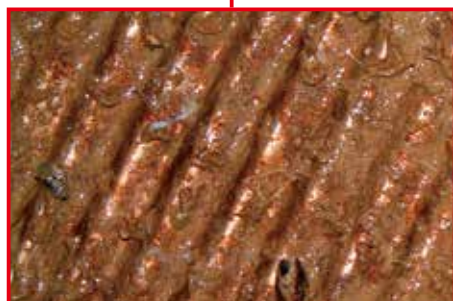
← プレート伝熱面 ヘドロや海洋生物が付着、堆積して伝熱障害を生じている。
