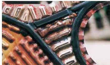
↑ 発錆下で応力腐食割 (後述) も発生
