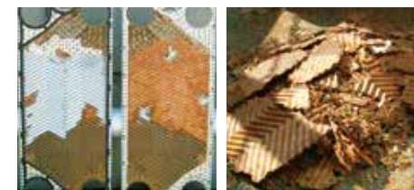
↑ プレート内部で固化したハードスケール
