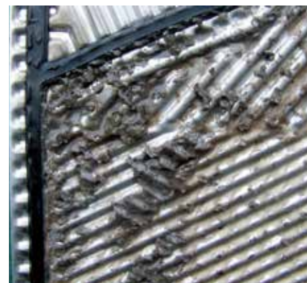
↑ プレート表面に堆積したスケール
