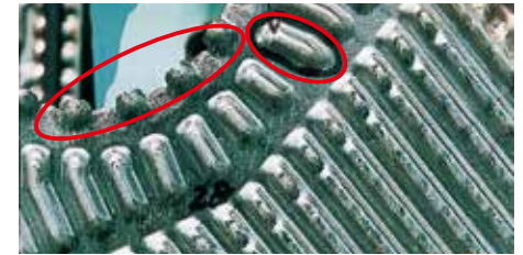
↑ 激しい全面腐食で板厚減少大
